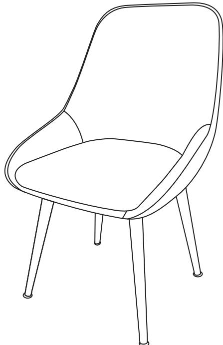
構造部材：鉄パイプ、合板
