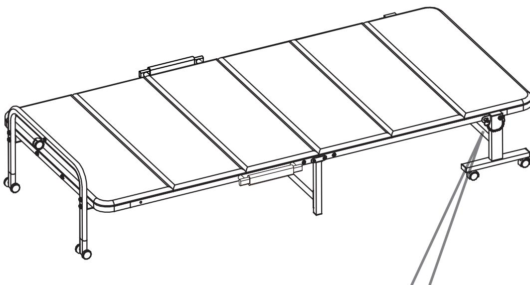
開き止めバーは必ず、フレームの穴に通し、奥までしっかり押し込む(左右2ヵ所)
