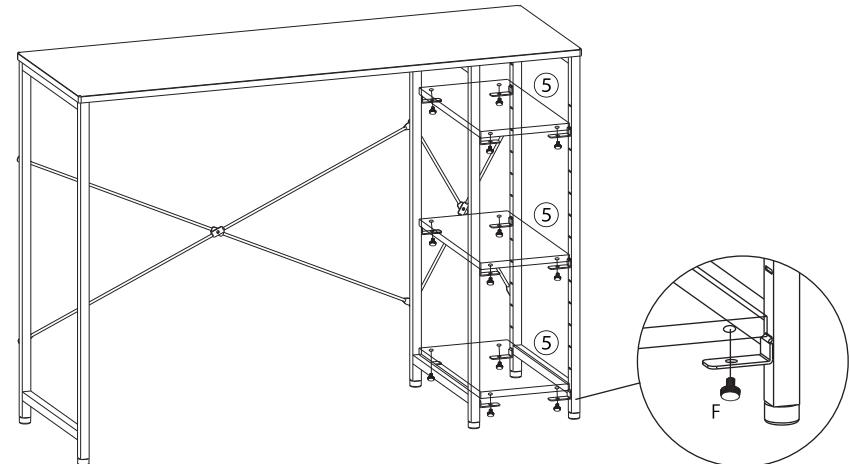
⑤棚板をE.棚板用パーツの上に乗せ、F.棚板用ネジで固定します。
