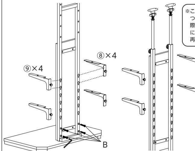
※こちらのネジは棚受け金具についております。取り付ける際はネジを緩めてからポールに差し込み、その後ネジを再度締めて固定してください。
