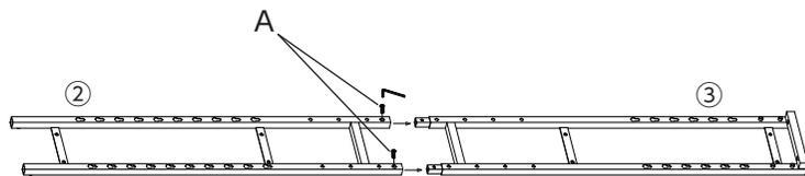
反対側にして①突っ張りポールをフレーム上部に差し込み、H調整のぶで軽く締めておきます。
