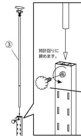
※調節のぶは予めフレームについておきますので、調節のぶをゆるめてから突っ張りポールを差し込み、再度調節のぶを回して固定してください。
