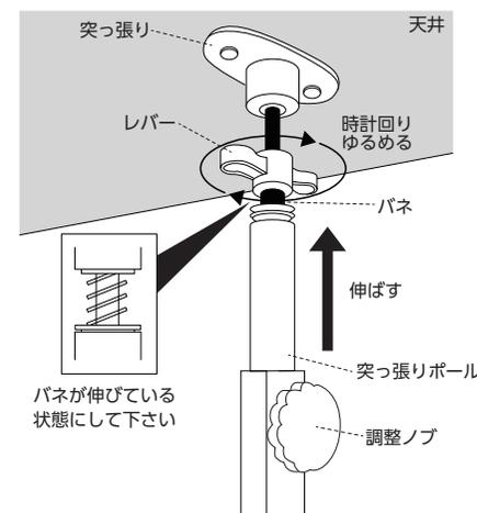
次にレバーを反時計回りに回して天井とポールを固定します。
