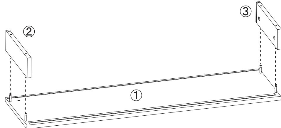
3 側板にBカムロック受けを取り付け、ドライバーで締めて固定します。
