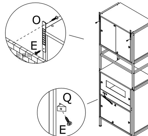
壁際に設置する際は、転倒防止に O: 転倒防止用プレートを本体と壁面に図のように取り付けてください。※壁用のネジは、壁の材質に合ったものをご利用ください。
