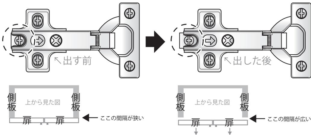
扉を本体に取り付けた後、扉を開閉して扉と本体側板の間隔をご確認ください。側板と扉の間隔が狭いと、扉を開閉する際に側板に干渉し、側板が傷つく場合があります。先ほど出した約3mmが丁度いい間隔の目安になりますが、もし開閉の際、扉の端が本体側板に当たったり、するようでしたら、再度「間口調節ネジ」をゆるめて微調節してください。
