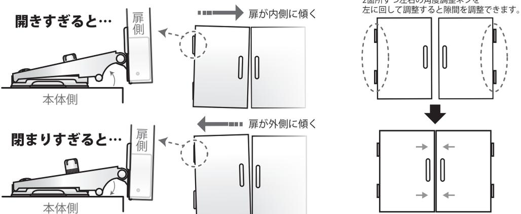
ヒンジは通常上下2つで1セットなので、「角度調節ネジ」を回すときは、上下のヒンジを合わせる必要があります。片方だけ角度が違くと扉の傾きの原因になりますので、扉の傾きや隙間が気になる時は、ネジの回転数(1回転、2回転…)を上下であわせて、ヒンジの角度を同じにしてあげる事で、扉をまっすぐ取り付けすることができます。
