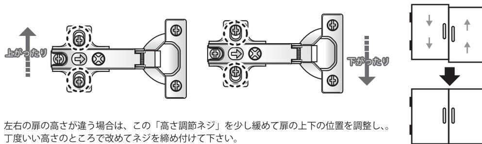
左右の扉の高さが違う場合は、この「高さ調節ネジ」を少し緩めて扉の上下の位置を調整し、丁度いい高さのところまで改めてネジを締め付けて下さい。
