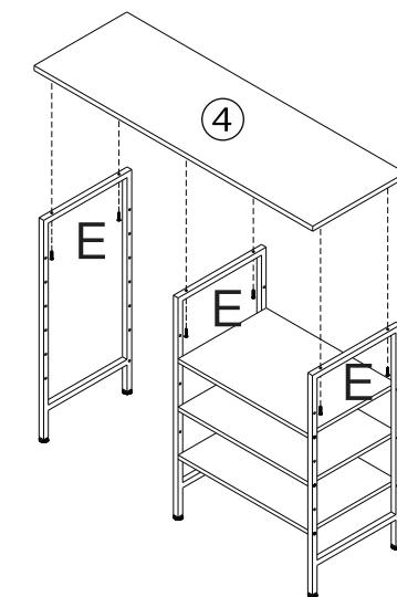
ステップ1とステップ2で組み立てた鉄脚を起こし、その上に④をEネジ中を使用して図のように取り付けます。
