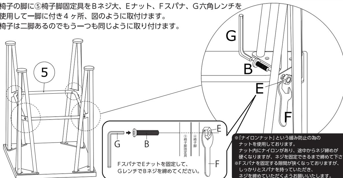
※「ナイロンナット」という緩み防止のためのナットを使用しております。ナット内にナイロンがあり、途中からネジ締めが硬くなりますが、ネジを固定できるまで締めて下さい。
