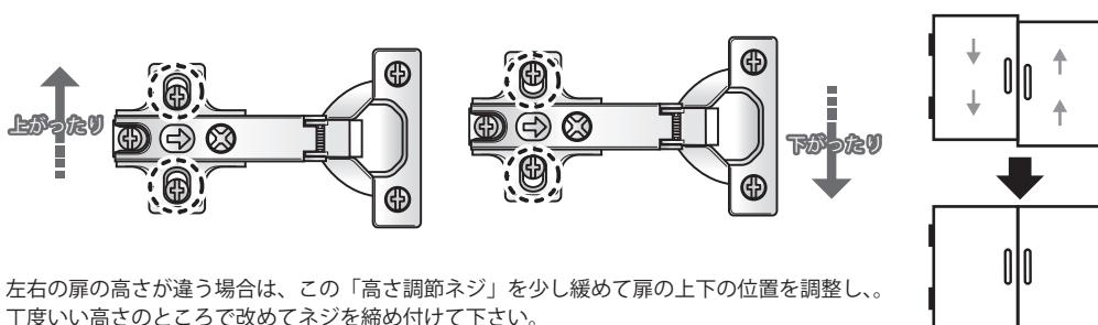
左右の扉の高さが違う場合は、この「高さ調節ねじ」を少し緩めて扉の上下の位置を調整し、丁度いい高さのところで改めてネジを締めてください。
