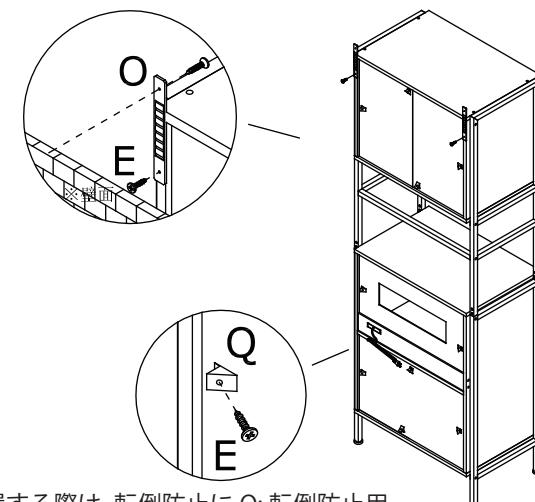
壁際に設置する際は、転倒防止にO:転倒防止用プレートを本体と壁面に図のように取り付けてください。
