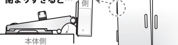
扉に隙間がある場合、2箇所ずつ左右の角度調整ねじを左に回して調整すると隙間を調整できます。
