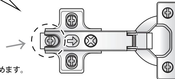
○で囲われている部分のネジが緩んでいる場合は、必ずしっかりとネジを締めてから扉に取り付けてください。※ネジが緩んでいると扉から外れてしまう恐れがございます。
