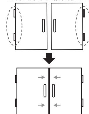
ヒンジは通常上下2つで1セットなので、「角度調節ねじ」を回すときは、上下のヒンジを合わせる必要があります。片方だけ角度が違うと扉の傾きの原因になりますので、扉の傾きや隙間が気になる時は、ネジの回転数(1回転、2回転...)を上下であわせて、ヒンジの角度を同じにしてあげる事で、扉をまっすぐ取り付けることができます。
